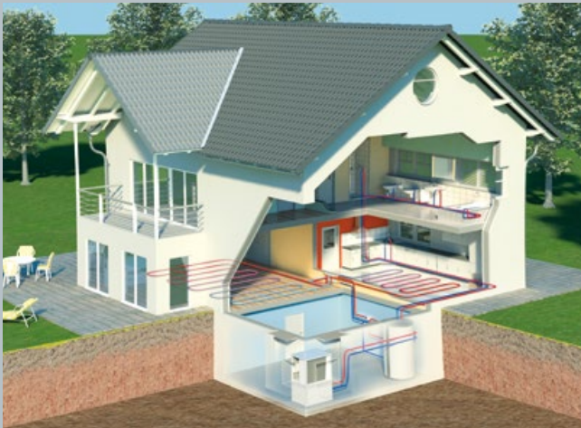
Innenaufstellung einer Wärmepumpe AEROTOP T
