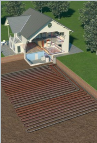
Erdwärmennutzung mit Erdregister
